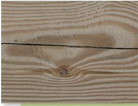
**Spannungsriss durch die Holz Trocknung**
