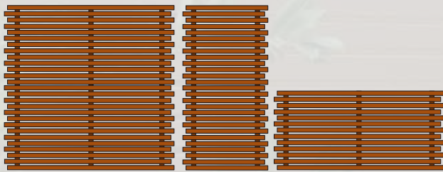
H = horizontaler Verlauf bei Befestigung mit L-Winkel bitte Schraube 7007350VT verwenden
